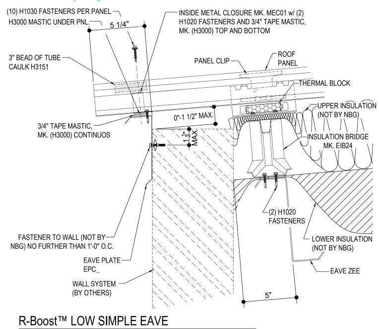
LOW SIMPLE EAVE DETAIL W/ WALL OPEN FOR WALL SYSTEM BY OTHERS
