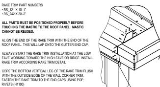
RAKE TRIM. COPE AS SHOWN. DO NOT FASTEN THE RAKE TRIM TO WALL PANEL
