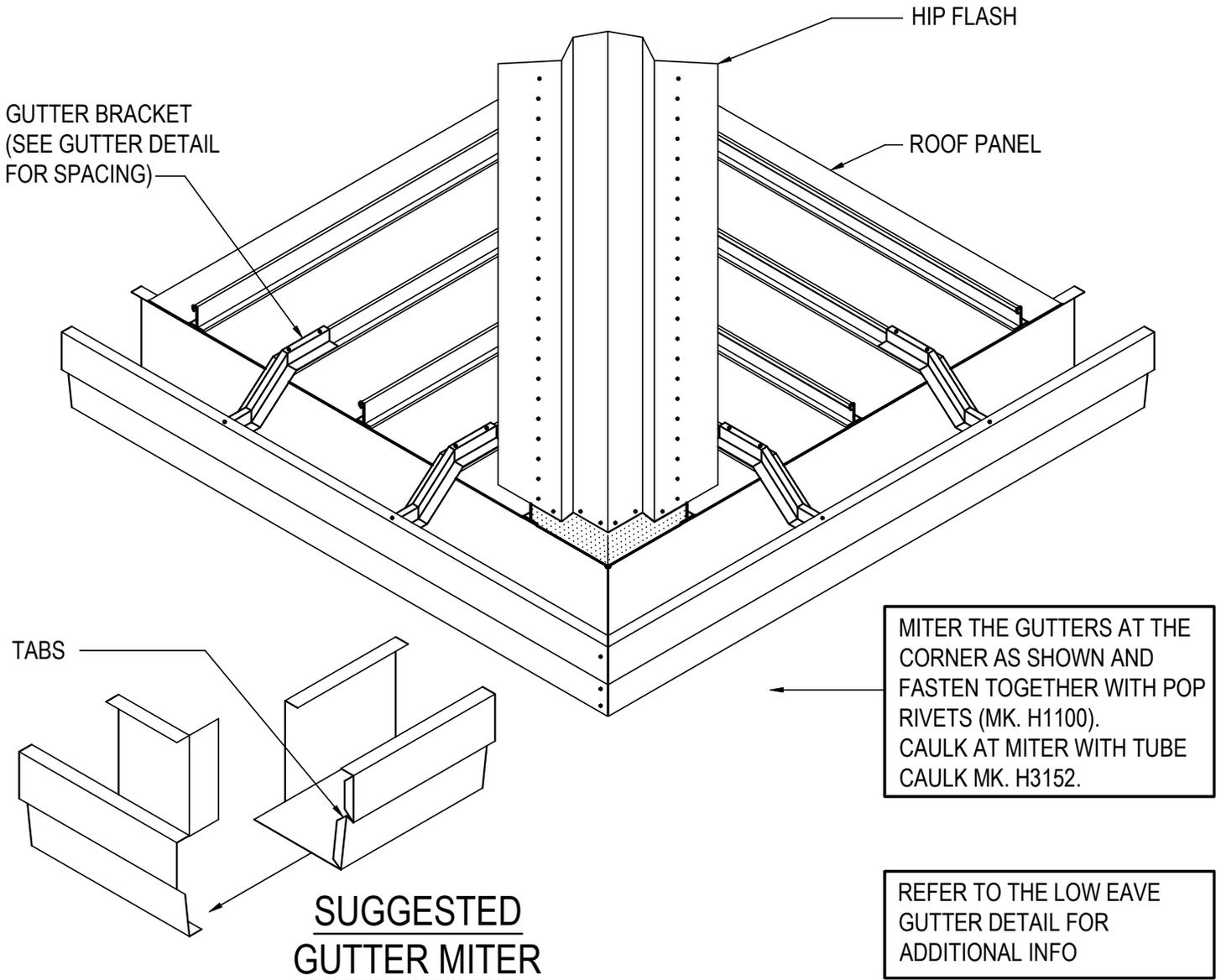
**LOW EAVE GUTTER AT HIP - LOC SEAM**
