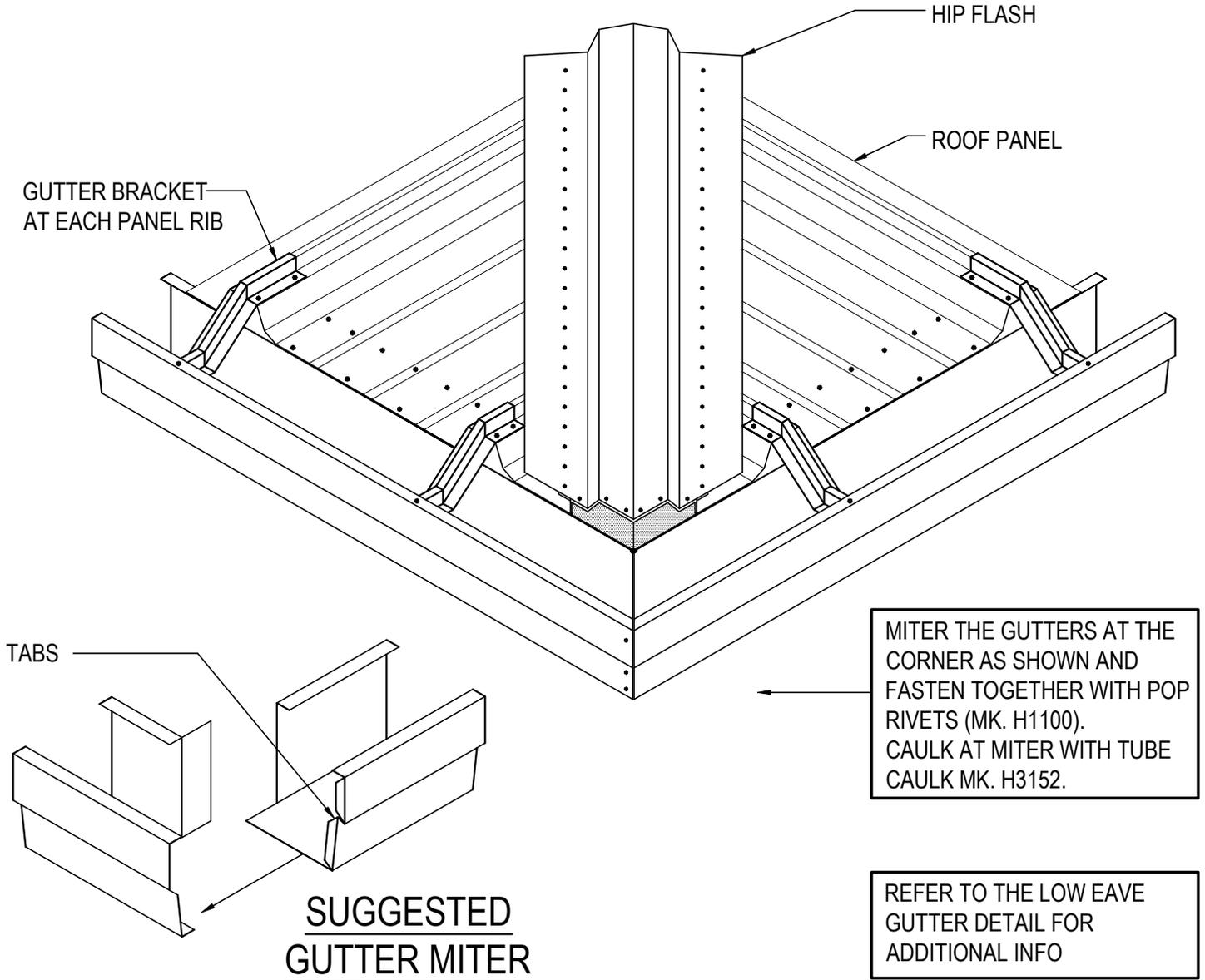
**LOW EAVE GUTTER AT HIP - SSII / SS360**
