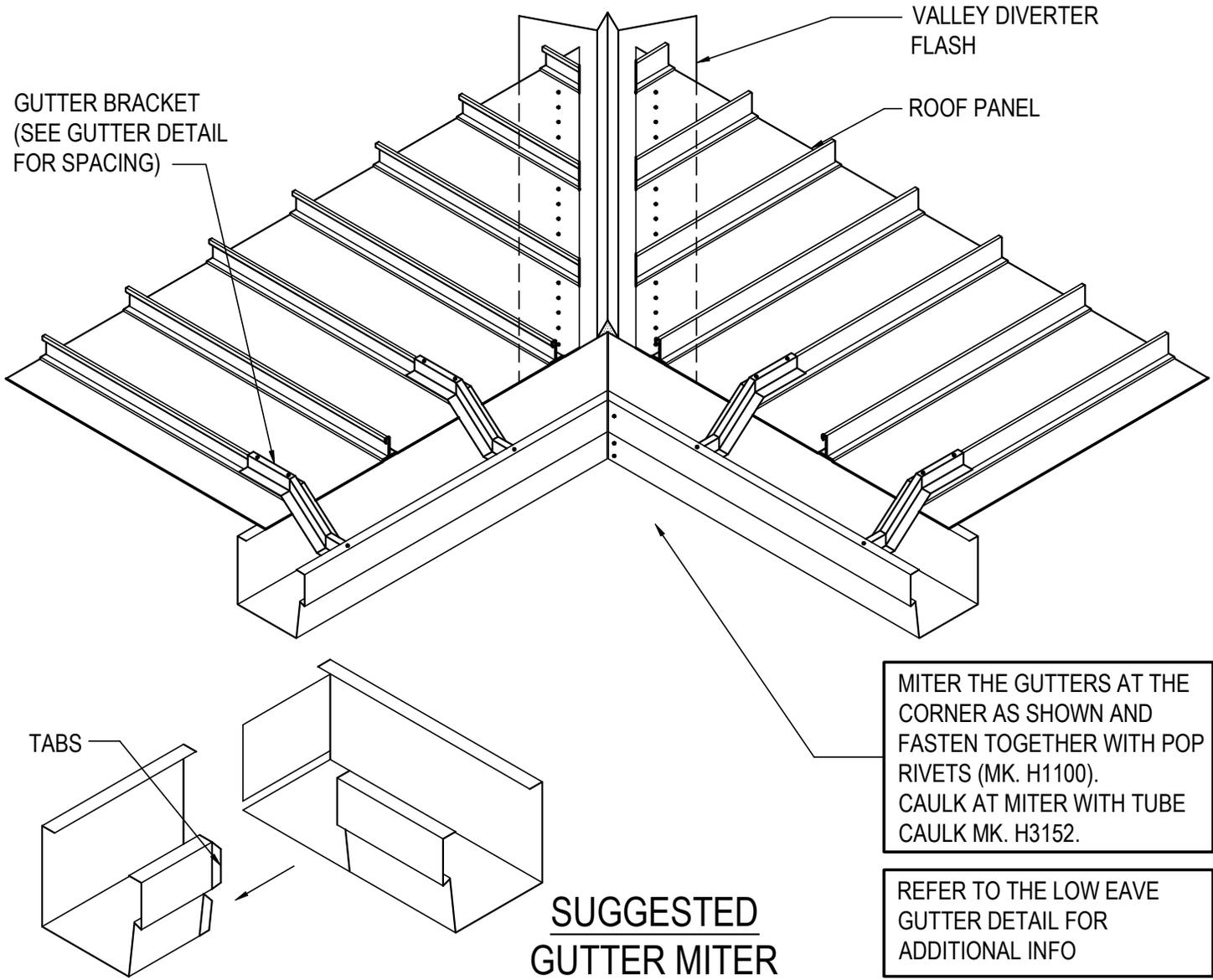
**LOW EAVE GUTTER AT VALLEY - LOC SEAM**
