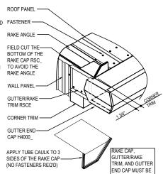
INSTALLED BEFORE THE RAKE TRIM.
