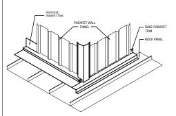
HIGH EAVE PARAPET LOW BUILDING EXTENDS STEP 6 WALL PANEL - OPTION 1
